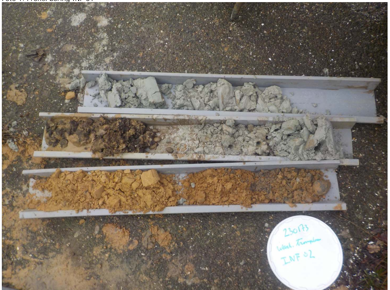
Foto 2. Profiel boring INF 02
