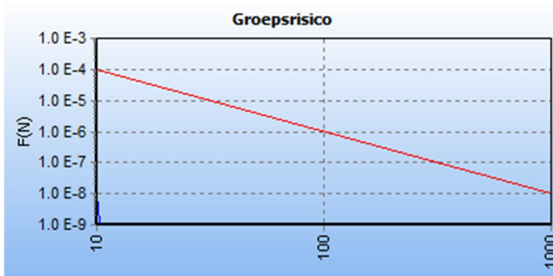
Afbeelding 12 fN-curve buisleiding A-585-deel-1, beoogde situatie
