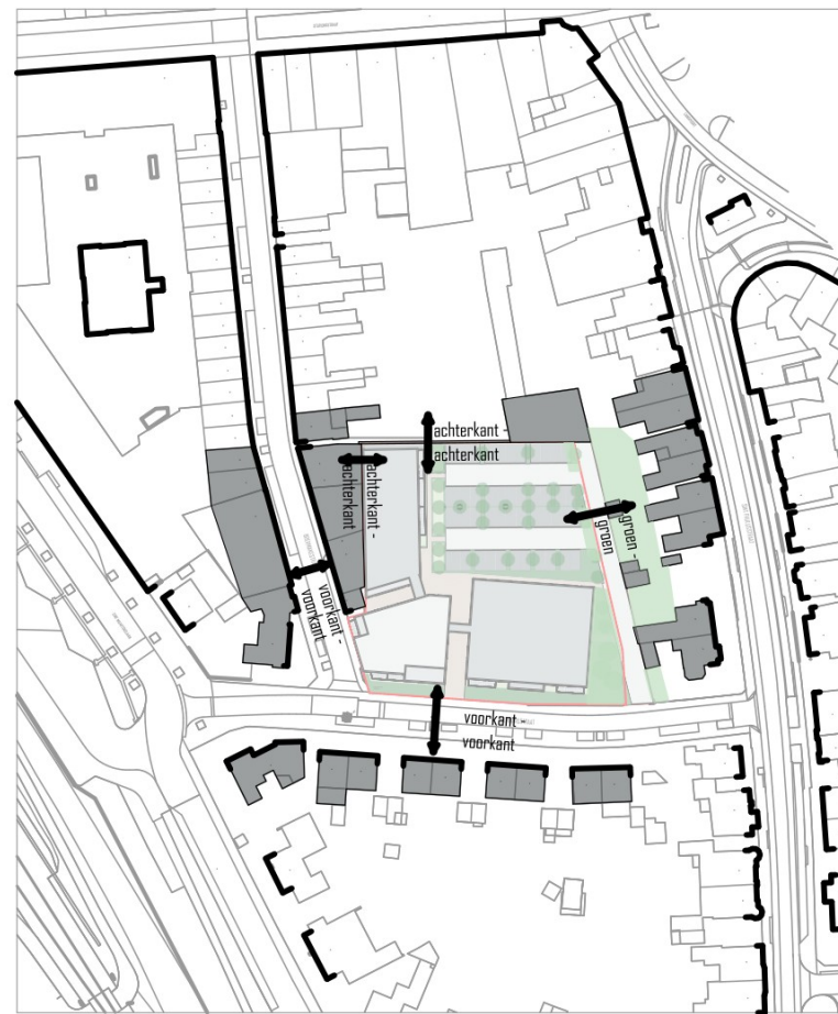
Omliggende bebouwing: Het nieuwe volume is een reactie op de bestaande omgeving. Er worden aan de Drehmansstraat voorkant-voorkant situaties gecreëerd en aan de rechter zijde wordt een groene buffer toegevoegd.
