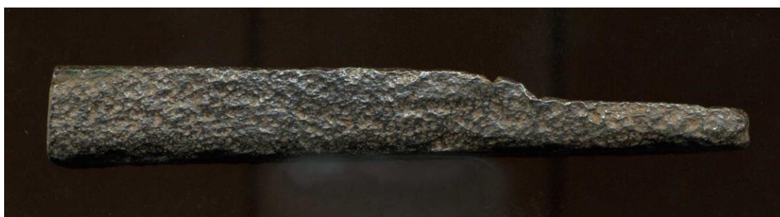
Fig 14 en 15. Boven- en zij-aanzicht van het uiteinde van een tijdens de brand gebroken schieter van een muuranker met dubbele Andreaskruisversiering (1750). Foto's: Alfons Bruekers.
