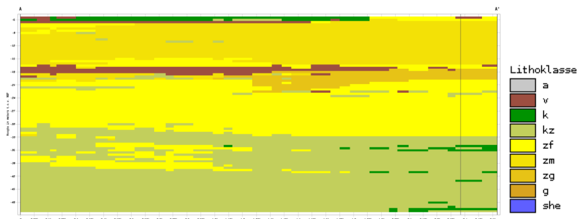
Figuur 6-8: bodemsamenstelling (richting oost-west), met in groen de kleilaag, geel zandige lagen en rood veen.
