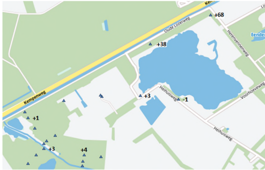
Figuur 3.3. Verschillen tussen de berekende en de gemeten gemiddelde grondwaterstand in cm. Positief betekent berekend is hoger dan gemeten.
