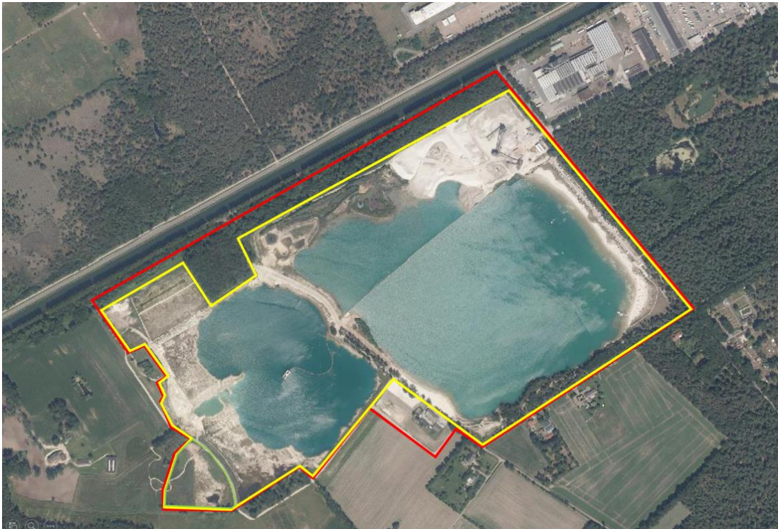
Figuur 1.1 Ligging van het ca. 60ha. grote plangebied. De rode lijn is de plangrens. De gele lijn is de concessiegrens volgens de Wijziging Ontgrondingsvergunning Kenmerk: 2016/58220 d.d.28 juli 2016. Het gebied binnen de groene lijn wordt conform de ontgrondingsvergunning niet ontgraven, omdat dit bevindt binnen de 200 m. ontgravingsgrens ten opzichte van natuurgebied Kruispeel.
