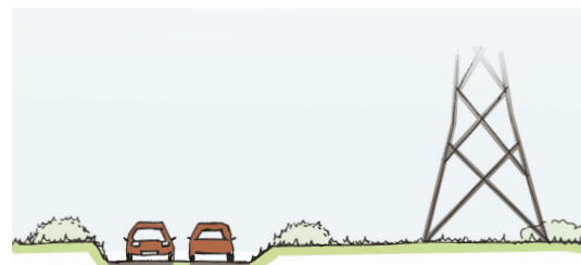
Afb. 67. Linksboven: de gebiedsontsluiting wordt zoveel mogelijk gebundeld met de hoogspanningsverbinding. Rechtsboven: Waar de route de spoorlijn kruist wordt voorzien in een onderdoorgang. Onder: we willen onderzoeken of het tot de mogelijkheden behoort om de route -in het verlengde van de spoorwegonderdoorgang - ook op andere plekken verdiept aan te leggen. Voordelen hiervan is dat het landschap minder verstoord wordt en dat eventuele geluidsoverlast mogelijk beperkt wordt.
