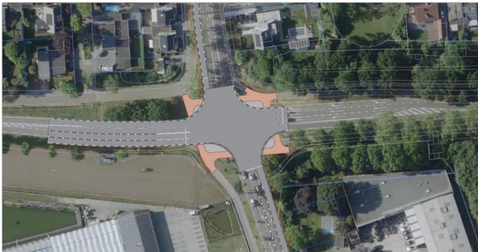
Figuur 15: verbeelding bouwsteen 2.1: uitbreiding en aanpassing opstelstroken VRI
