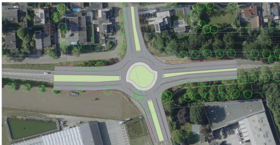
Figuur 17: verbeelding bouwsteen 2.2: transformatie tot turbo-rotonde
