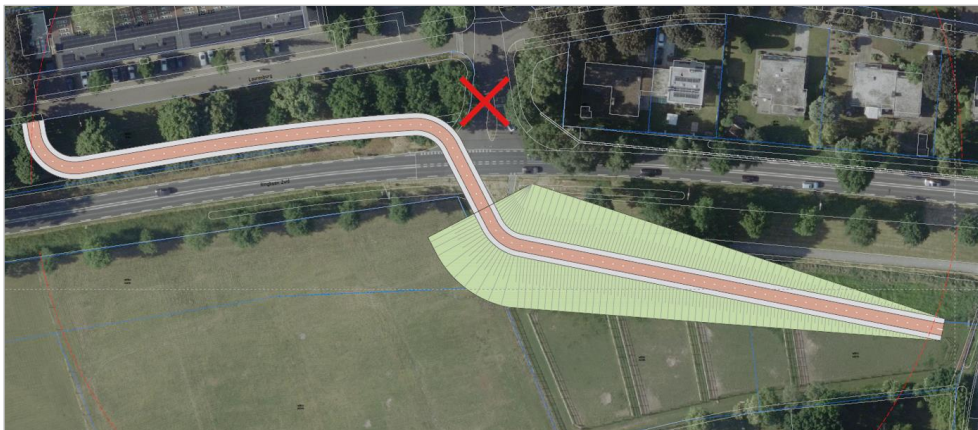
Figuur 23: verbeelding bouwsteen 3.3: aanleg fietsbrug en opheffing aansluiting Ringbaan-Zuid/Johan Willem Frisolaan
