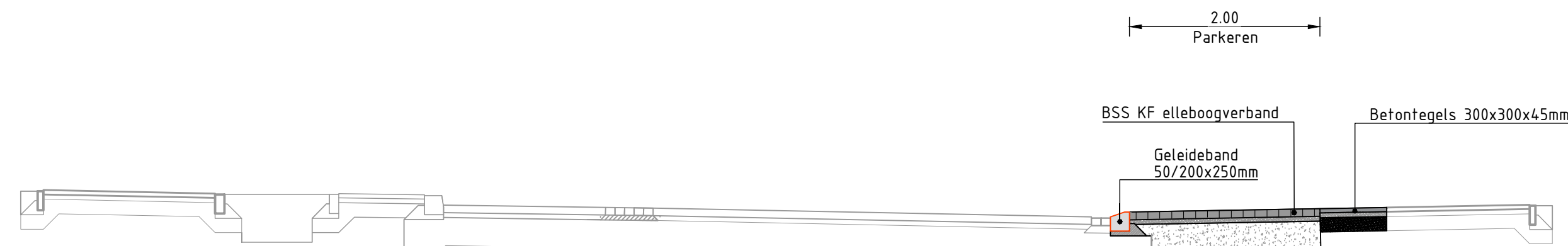
Dwarsprofiel A-A Johanna van Polanenstraat variant 3 schaal 1:50
