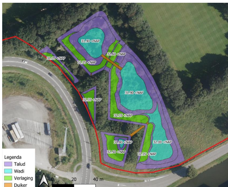
Figuur 3: Concept-schets van de inrichting van de waterbuffers ten westen van Sportpark Boshoven. Deze inrichting is niet definitief. aangezien door de gemeente wordt gekeken naar mogelijkheden om de wadi's zo veel mogelijk te verdelen binnen het sportpark.
