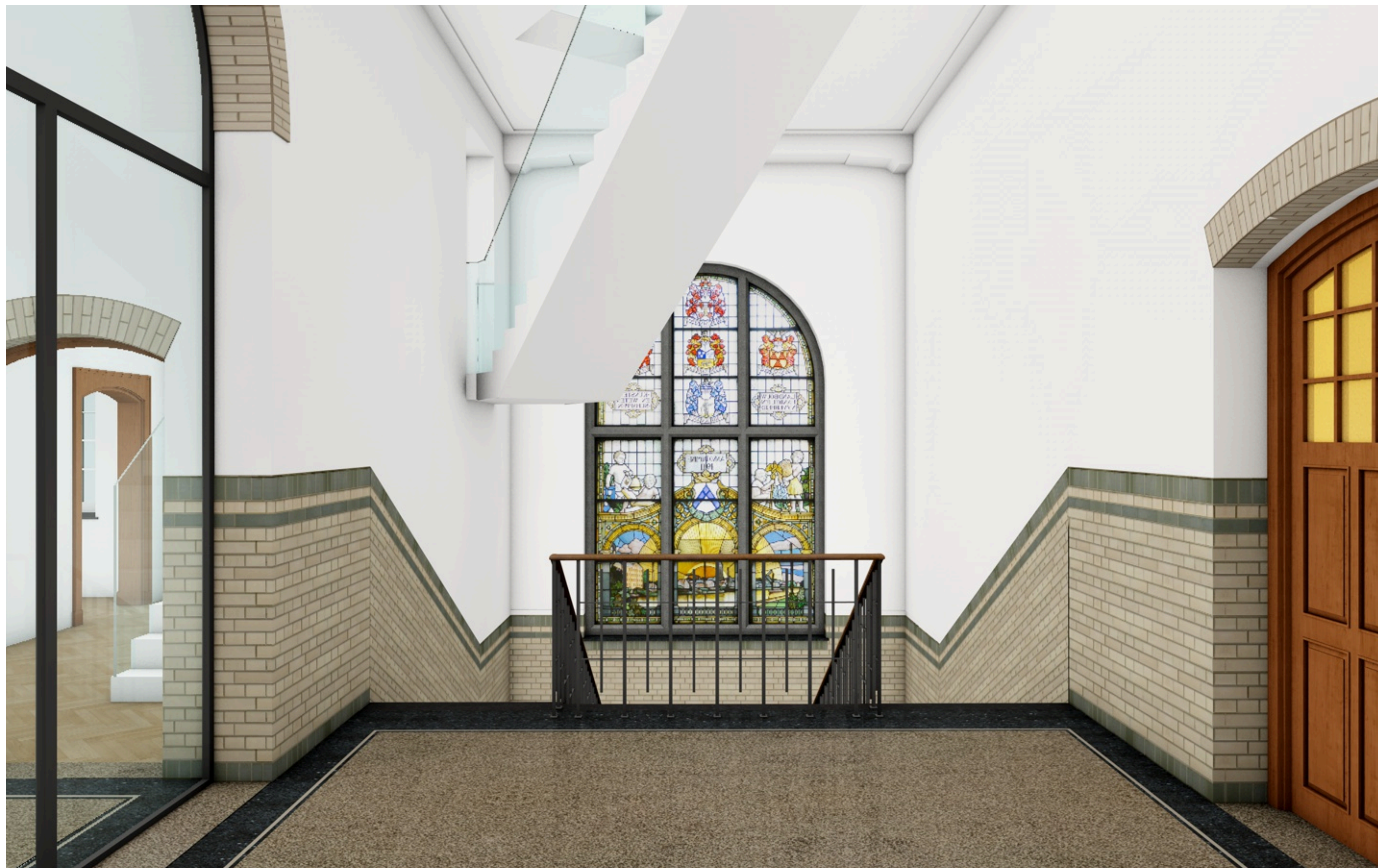
1.01 Door de trap naar de zolder te starten in de naastgelegen ruimte 1.08 blijft de ruimtelijkheid en het zicht op het glas in lood raam behouden 54 De schuine trapsteek wordt als een nieuwe toevoeging vormgegeven, eventueel ook in een andere kleur of materiaal.
