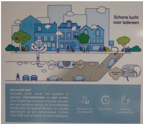
Foto: uitleg hoe het werkt op de filterinstallaties
